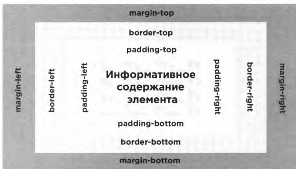
Рис. 4.1. Схема стилизованного блока, с указанием CSS-свойств, задающих размеры соответствующих областей
