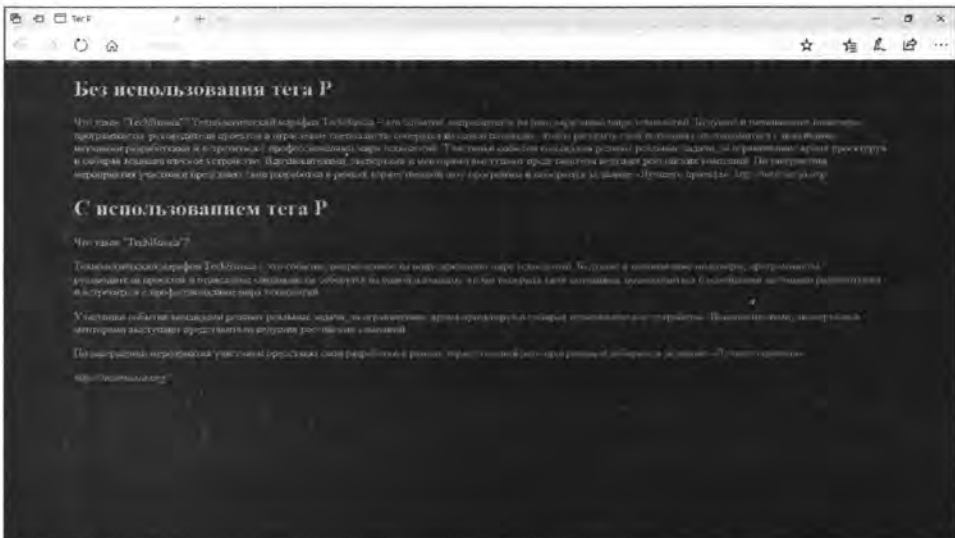
Рис. 5.2. Пример использования тега P для разбиения на абзацы. Сверху текст представлен без разбиения на абзацы, а снизу – с разбиением
